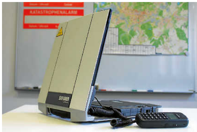
Satellitenkommunikationsanlage, welche bei allen Projektpartnern ortsfest installiert wurde.
