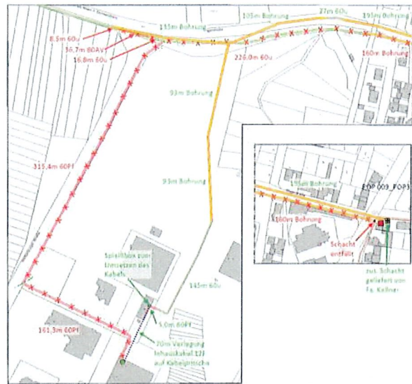
Abbildung 4: Spülbohrung neben einer bestehenden Gashochdruckleitung in Durmersheim
