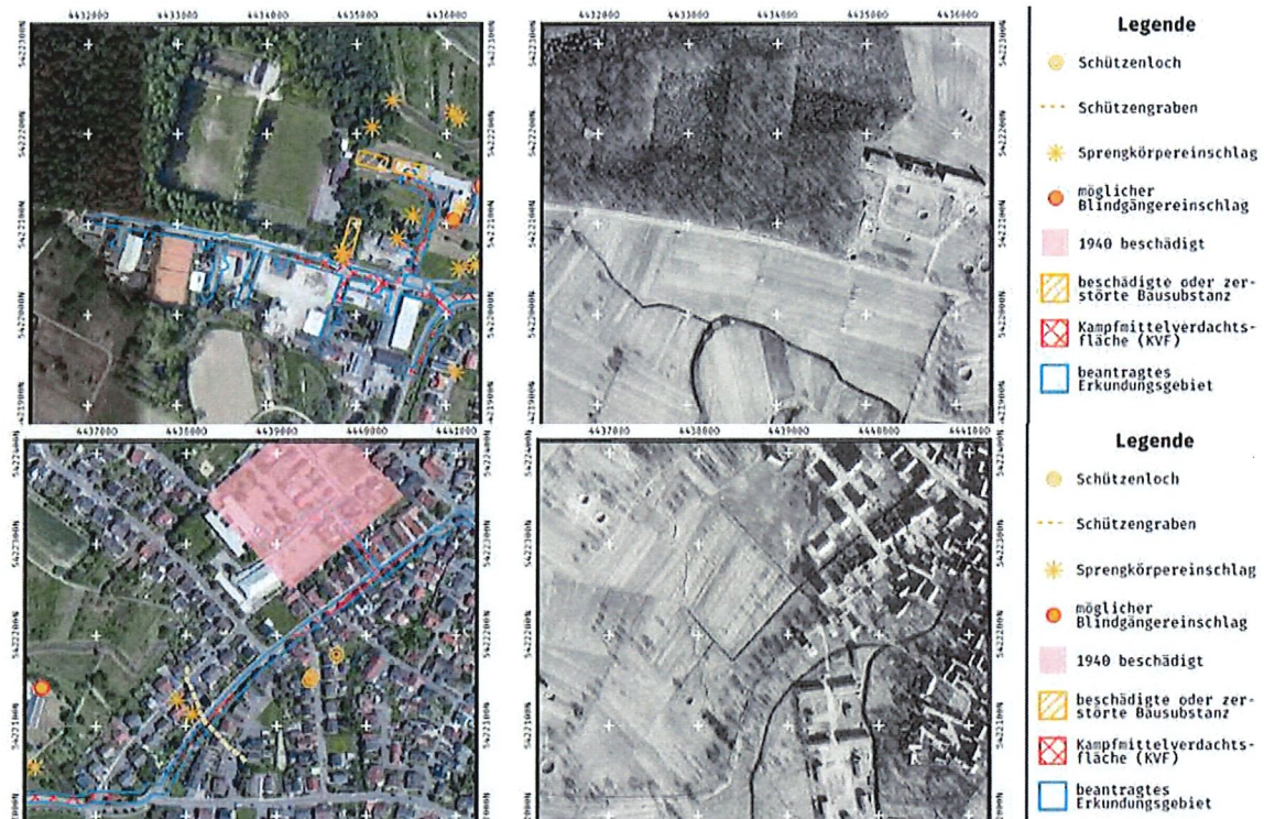
Abbildung 112: exemplarische Luftbildauswertung im Vorfeld der Baumaßnahmen zur Überprüfung des Verdachts auf Kampfmittelbelastung
